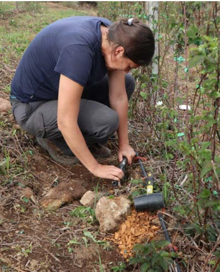
Abb. 2: Installation von Wassersensoren unter Agroforst-Bäumen
